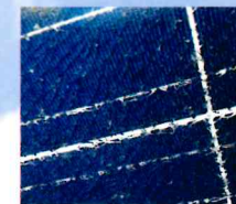
ひび割れ・経年劣化
