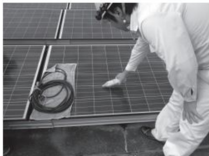
図7 セルラインチェッカーによる不具合特定
